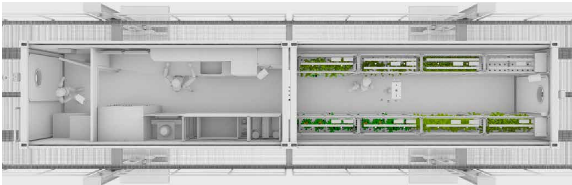
Ein Computergrafik-Blick von oben in das EDEN-ISS Gewächshaus, bestehend aus einem Container für Schleuse und Arbeitsplatz (links) und einem für die Pflanzenzucht (rechts).
