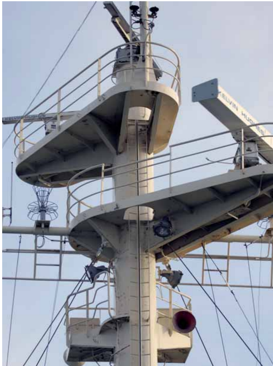
Der Antennenturm garantiert permanenten Kontakt via Satellit mit der Heimat-Zentrale in Murmansk. Satellitentelefon, Email und Funk sind auch im Eismeer selbstverständlich.
